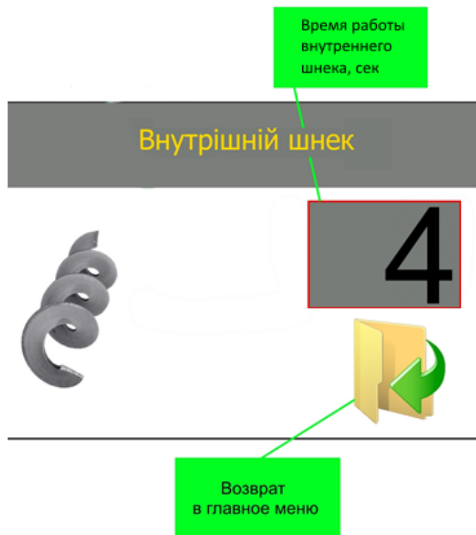
Рисунок 10 – Окно настройки работы внутреннего шнека
