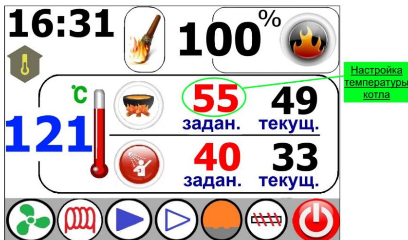
Рисунок 5 – Изменение температуры котла
