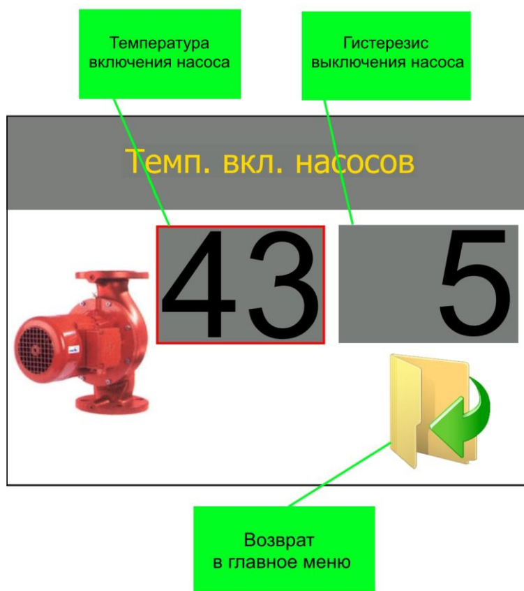
Рисунок 20 – Окно изменения параметров насоса
