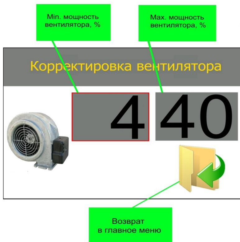
Рисунок 12 – Окно корректировки вентилятора
