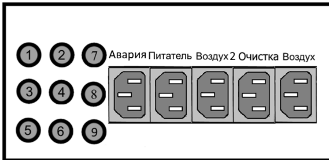
Рис. 2 – Задняя панель контроллера.
